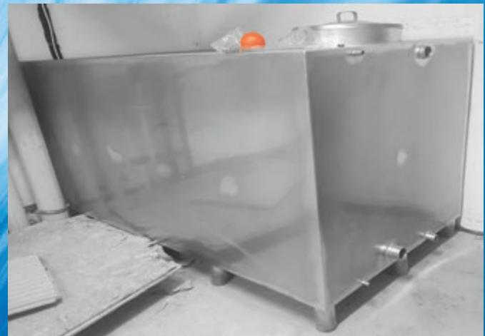
Paslanmaz kazan depo 500 litreden 100.000 litre Arasında istenilen ölçüde istenilen kapasitede su, süt, meyve suyu zeytinyağı, şarap, sirke, pekmez, çikolata, maya ve kimyasal, asit, glikoz, mazot gibi depolama tankları seçeneği sunulur. İmalatımızda birinci kalite sertifikalı AISI 304 paslanmaz çelik malzemeler kullanılmakta, imalat sonunda sertifikalarını müsteriye teslim etmekteyiz. Hijyen imalat esnasında malzemeyi korumak için imalatında pvc kaplı paslanmaz çelik malzemeler kullanmaktadır.
